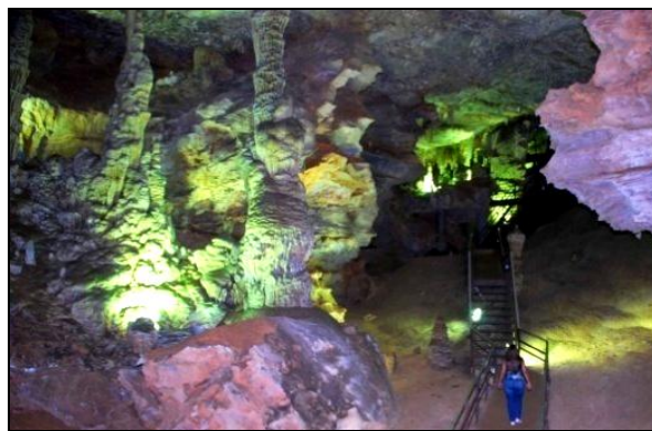
B – Distribuição deficiente da iluminação em trechos do caminhamento e excesso de luz no centro do espeleotema, causando ofuscamento e prejudicando a compreensão formal/ volumétrica do mesmo. Foto: V. Moura.
